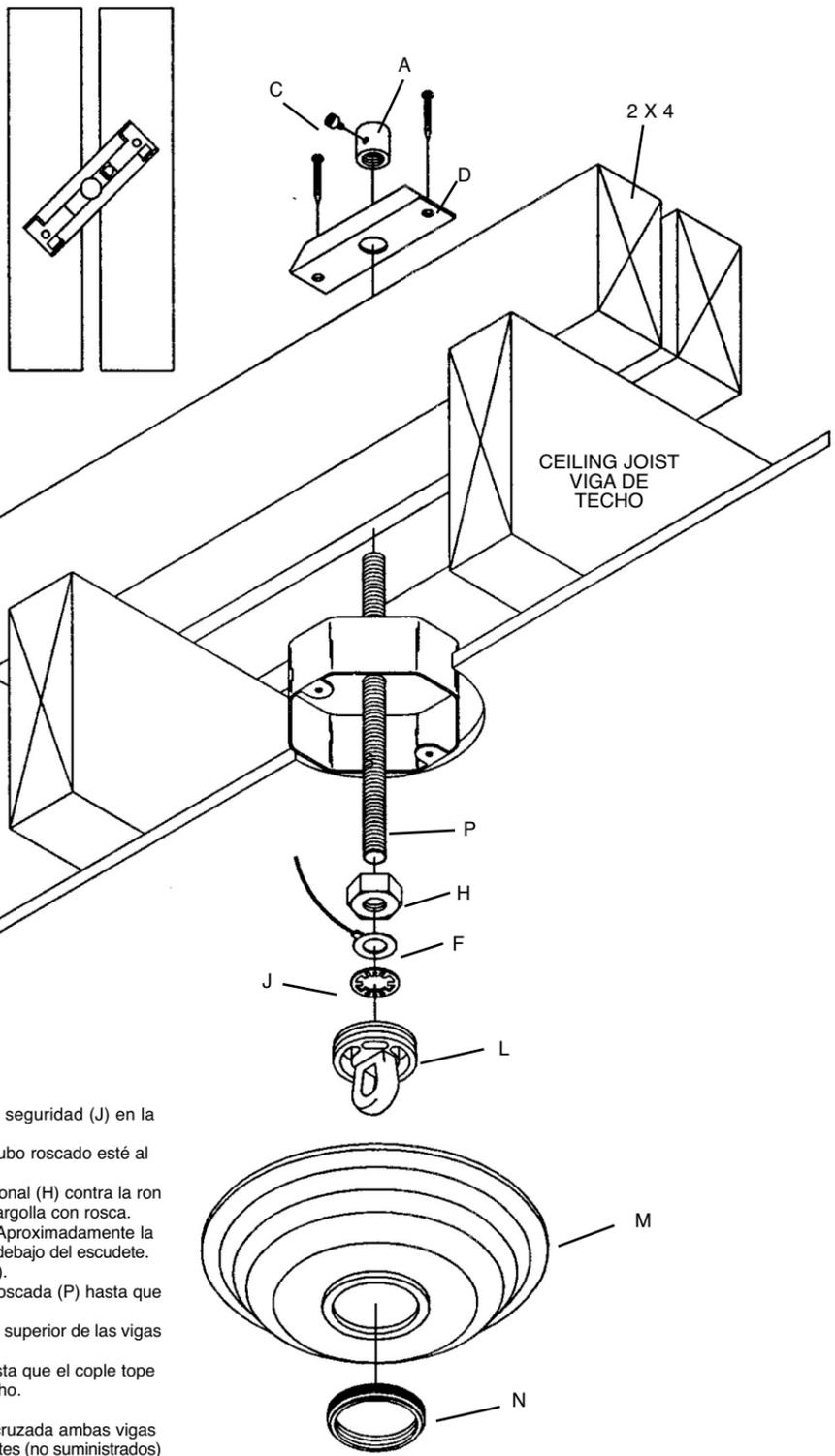
**LOS ADITAMENTOS DE SOPORTE DEBEN INSTALARSE SOBRE LA CAJA DE SALIDA. A CONTINUACIÓN SE SUGIERE UN MÉTODO DE INSTALACIÓN**
